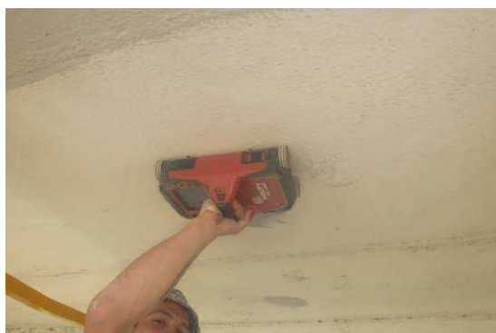
Obr. 10 Nedeštruktívne určovanie parametrov betonárskej výstuže
