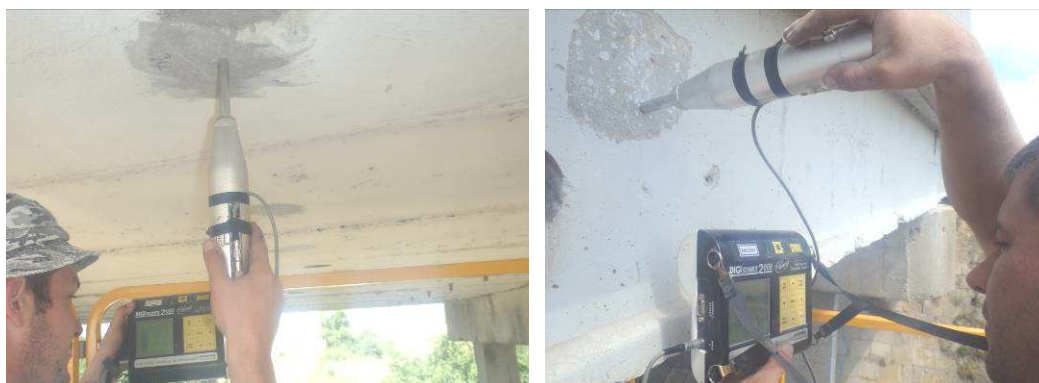
Obr. 7 Meranie Schmidtovým tvrdomerom DIGI - SCHMIDT 2000 ND
