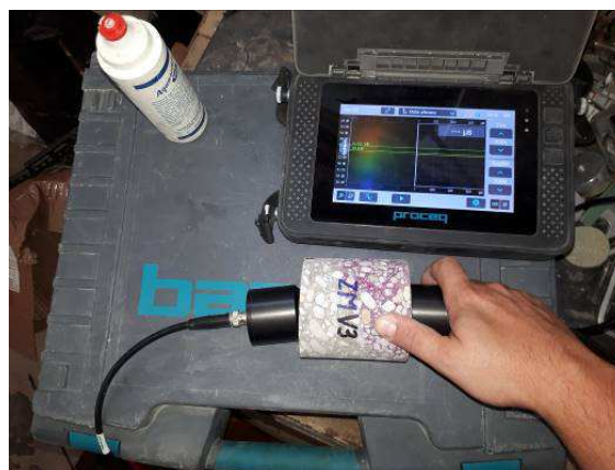
Obr. 12 Meranie modulu pružnosti ultrazvukovou metódou
