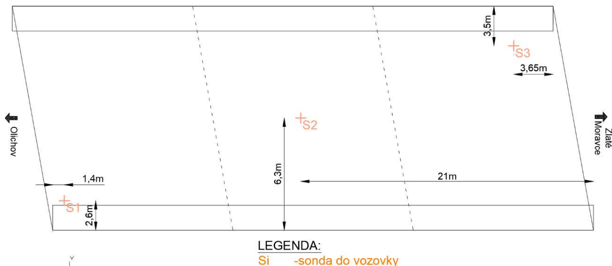
Obr. 6 Miesta zisťovania hrúbky a zloženia vozovky na mostnom objekte
