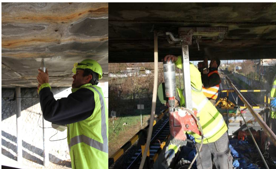
Obr. 7 Skúška Digischmidtom (vľavo) a odber vzorky jadrovou vŕtačkou (vpravo)
