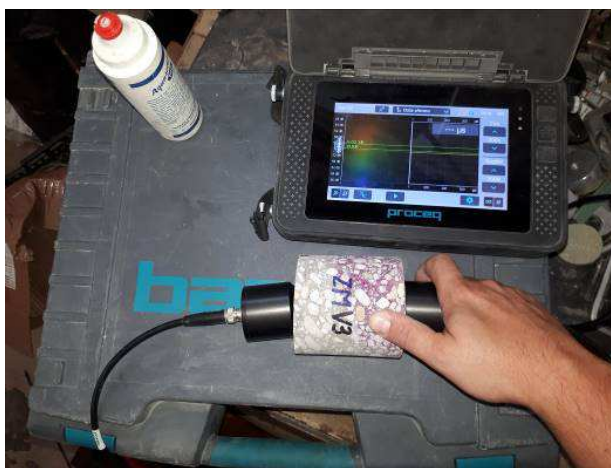
Obr. 8 Meranie modulu pružnosti ultrazvukovou metódou
