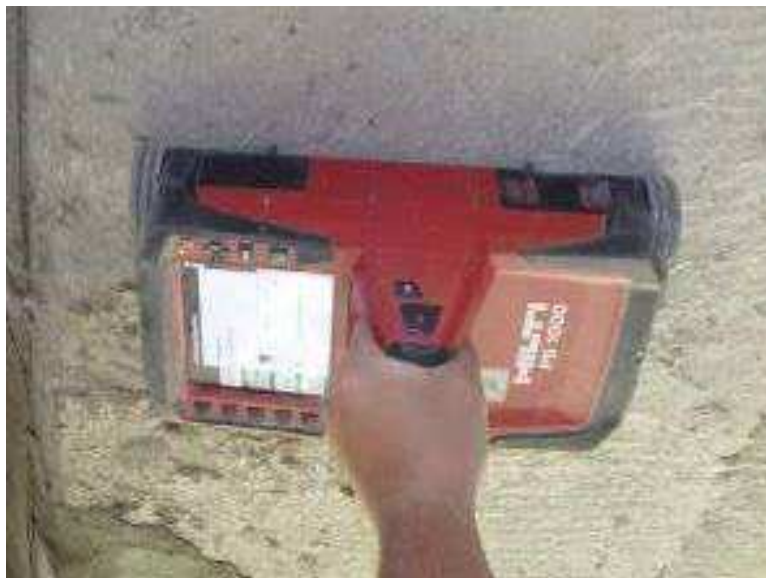
Obr. 2 Nedeštruktívne meranie polohy výstuže
