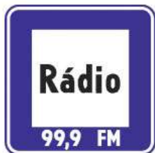
Obrázok 17.1 Vyznačenie frekvencie rozhlasovej stanice prijímateľnej v tuneli na dopravnej značke umiestnenej pred tunelom
