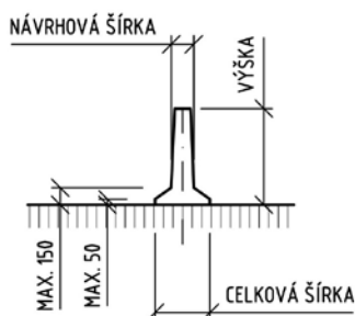
Obrázok 1 - Parametre priečného rezu dočasného zvodidla (rozmery v mm)
