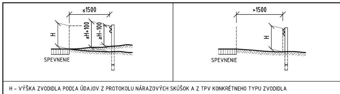
Obrázok 1 - Výška jednostranných zvodidiel (rozmery v mm)
