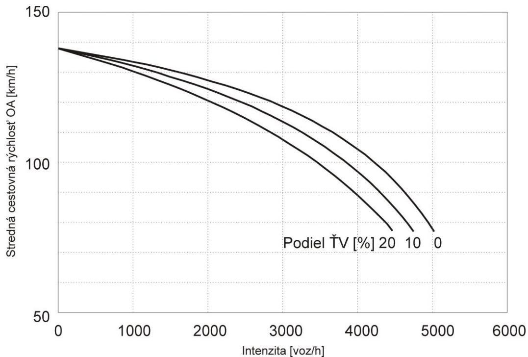
Obrázok 4.1(b) Stredná cestovná rýchlosť OA v závislosti na intenzite dopravného prúdu, stúpanie =  $3\%$  (3-pruhová diaľnica, mimo aglomerácie, bez obmedzenia rýchlosťi)
