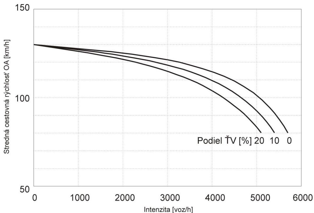
Obrázok 4.2(a) Stredná cestovná rýchlosť OA v závislosti na intenzite dopravného prúdu, stúpanie  $\leq 2\%$  (3-pruhová diaľnica, v aglomerácii, bez obmedzenia rýchlosťi)
