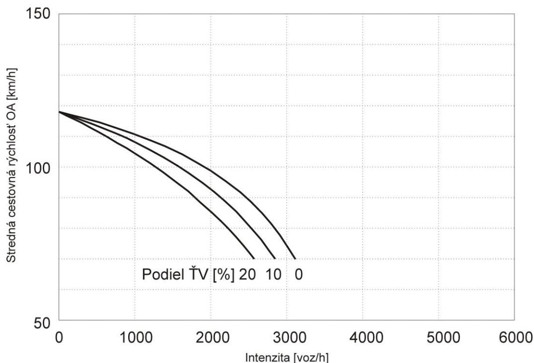
Obrázok 4.3(d) Stredná cestovná rýchlosť OA v závislosti na intenzite dopravného prúdu, stúpanie = 5 % (2-pruhová diaľnica, mimo aglomerácie, bez obmedzenia rýchlosťi)
