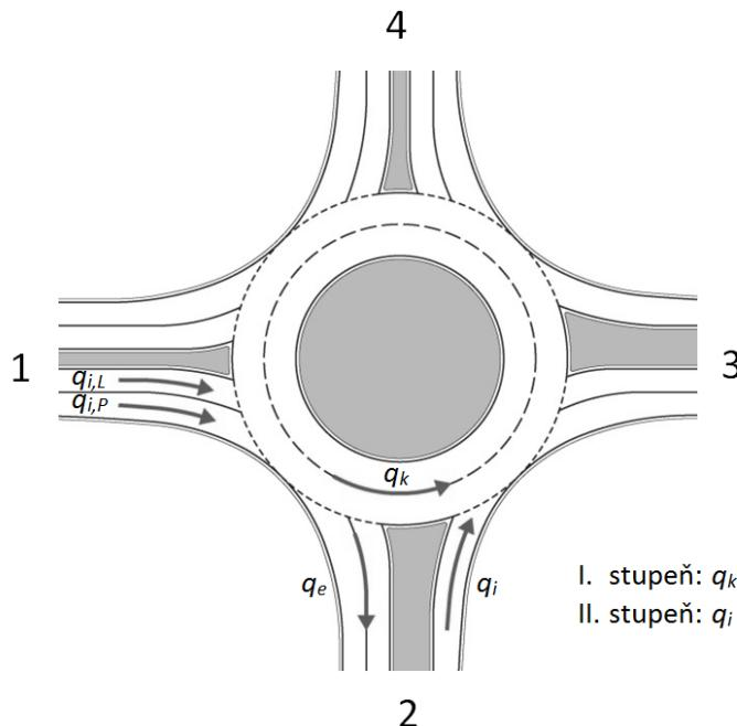
Obrázok 8.3 Označenie dopravných prúdov na okružnej križovatke
