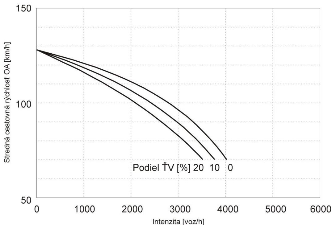
Obrázok 4.1(d) Stredná cestovná rýchlosť OA v závislosti na intenzite dopravného prúdu, stúpanie = 5 % (3-pruhová diaľnica, mimo aglomerácie, bez obmedzenia rýchlosťi)
