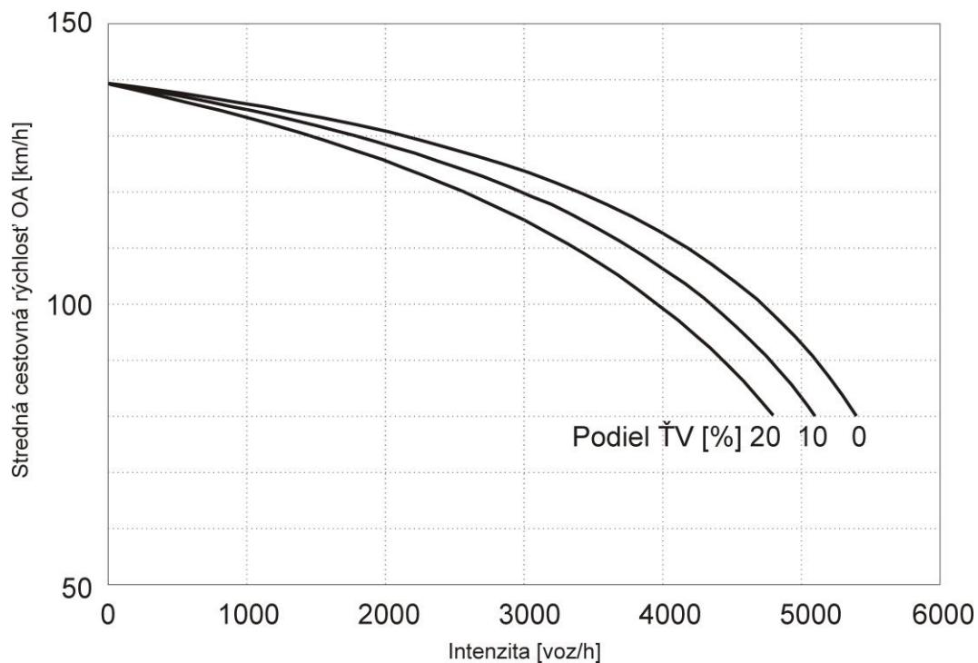
Obrázok 4.1(a) Stredná cestovná rýchlosť OA v závislosti na intenzite dopravného prúdu, stúpanie  $\leq 2\%$  (3-pruhová diaľnica, mimo aglomerácie, bez obmedzenia rýchlosťi)
