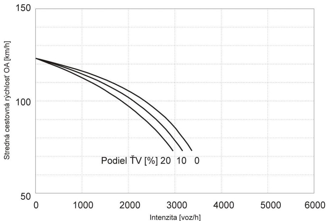
Obrázok 4.4(c) Stredná cestovná rýchlosť OA v závislosti na intenzite dopravného prúdu, stúpanie = 4 % (2-pruhová diaľnica, v aglomerácii, bez obmedzenia rýchlosťi)
