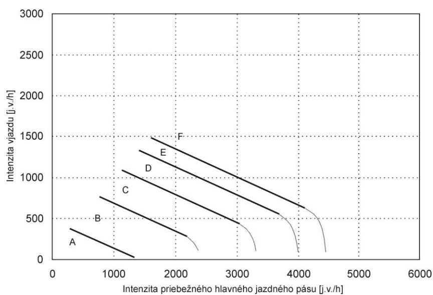
Obrázok 5.4 Stupeň kvality dopravných prúdov pre priebeh zaraďovania v závislosti od intenzity dopravy priebežných hlavných jazdných pásov a intenzity vjazdu pre typ vjazdu E1 a E2 na 2-pruhovom jednosmernom jazdnom páse
