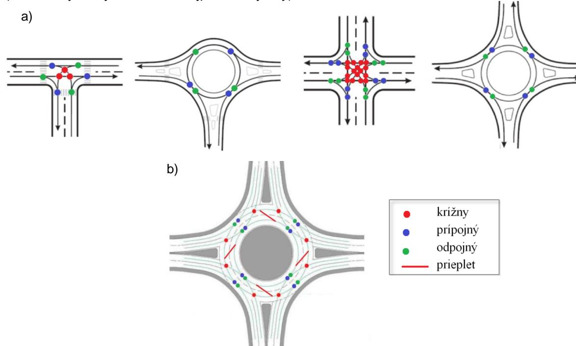
Obrázok 8.1 Kolízne body na: a) trojramenných a štvorramenných neriadených križovatkách a jednopruhových okružných križovatkách, b) dvojpruhovej okružnej križovatke
