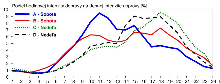
Obrázok 3.21 Priebeh „typickej krivky“ intenzity dopravy pre výkendové dni
