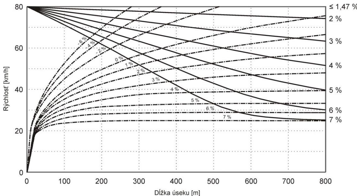
Obrázok 6.1 (detail) Rýchlosť profil pre ŤV pri rozličnom sklone
