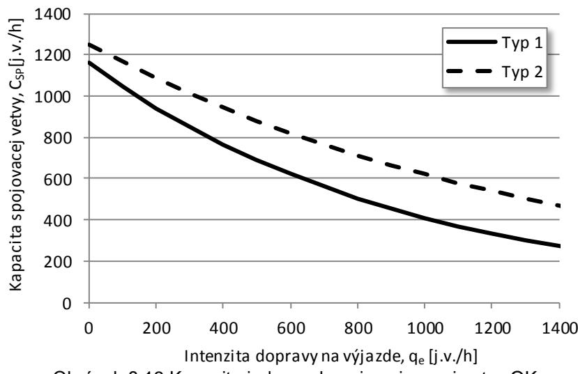
Obrázok 8.13 Kapacita jednopruhovej spojovacej vetvy OK
