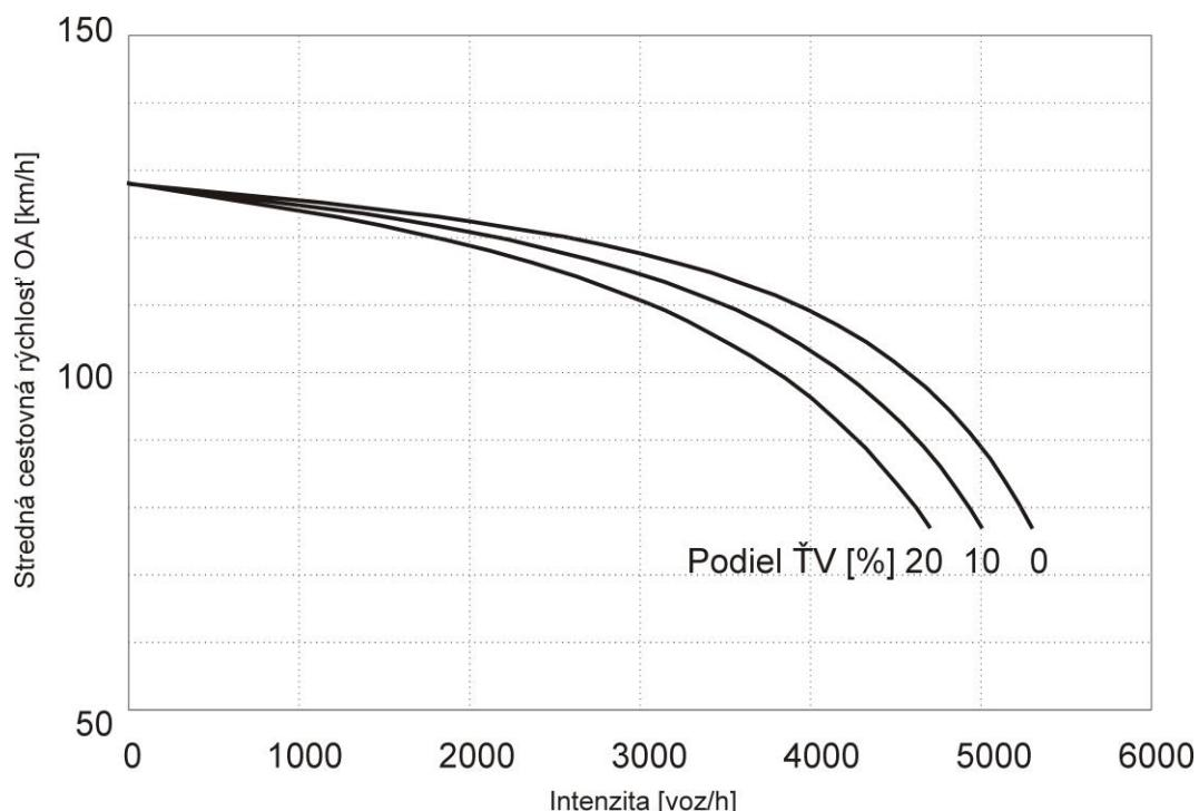
Obrázok 4.2(b) Stredná cestovná rýchlosť OA v závislosti na intenzite dopravného prúdu, stúpanie = 3 % (3-pruhová diaľnica, v aglomerácii, bez obmedzenia rýchlosťi)
