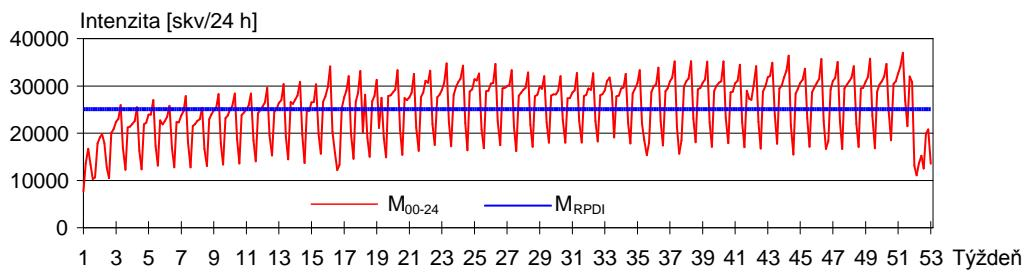
Obrázok 3.6 Ročný priebeh dennej intenzity dopravy - (príklad)
