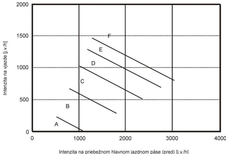
Obrázok 5.9 Stupeň kvality dopravných prúdov pre prepletanie na priebežnom 2-pruhovom hlavnom jazdnom páse typu V 1 v závislosti od intenzity priebežného hlavného jazdného pásu pred priepletovým úsekom a intenzity vjazdu
