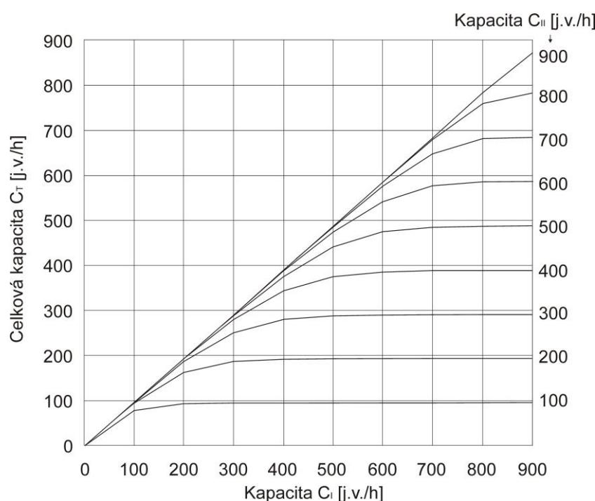
Obrázok 7.16b Kapacity  $C_T$  pre dopravné prúdy 4 + 5 a 10 + 11 v závislosti od kapacít čiastočných dopravných križovatiek rozdelenej prednosti v jazde
