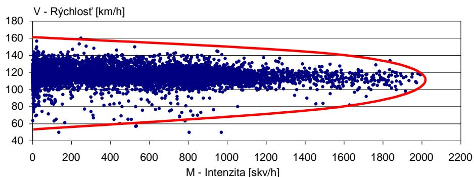
Obrázok 3.16 Vzťah intenzity dopravy a okamžitej rýchlosťi (M/V diagram)
