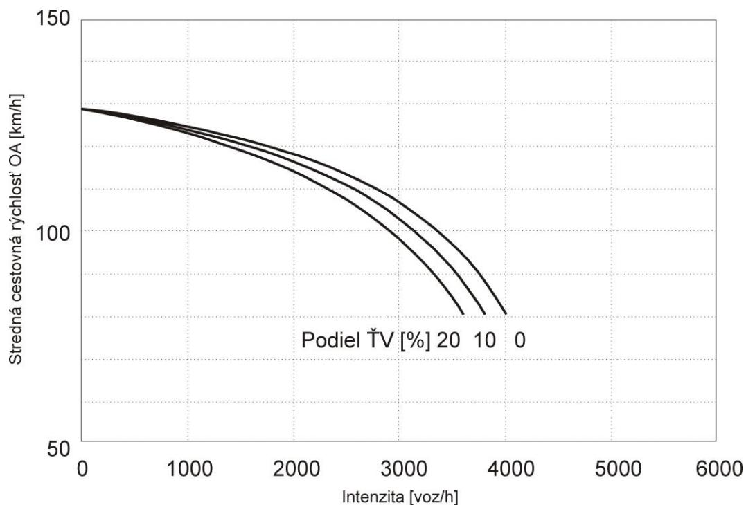
Obrázok 4.4(a) Stredná cestovná rýchlosť OA v závislosti na intenzite dopravného prúdu, stúpanie  $\leq 2\%$  (2-pruhová diaľnica, v aglomerácii, bez obmedzenia rýchlosťi)
