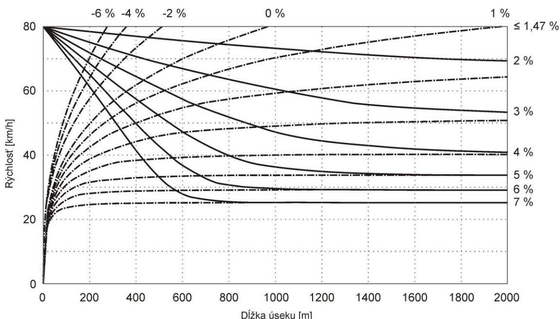
Obrázok 6.1 (všeobecne) Rýchlosťný profil pre ŤV pri rozličnom sklonovej rôzničke
