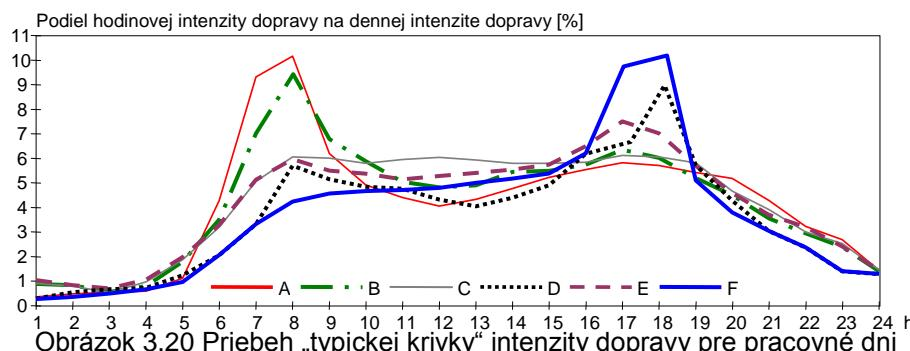
Obrázok 3.20 Priebeh „typickej krivky“ intenzity dopravy pre pracovné dni
