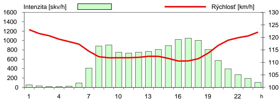
Obrázok 3.19 Závislosť medzi priebehom dennej intenzity dopravy a priemernej okamžitej rýchlosťi
