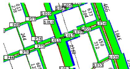
Obrázok 3.26 Začaženie komunikačnej siete s rozdelením druhu dopravy
