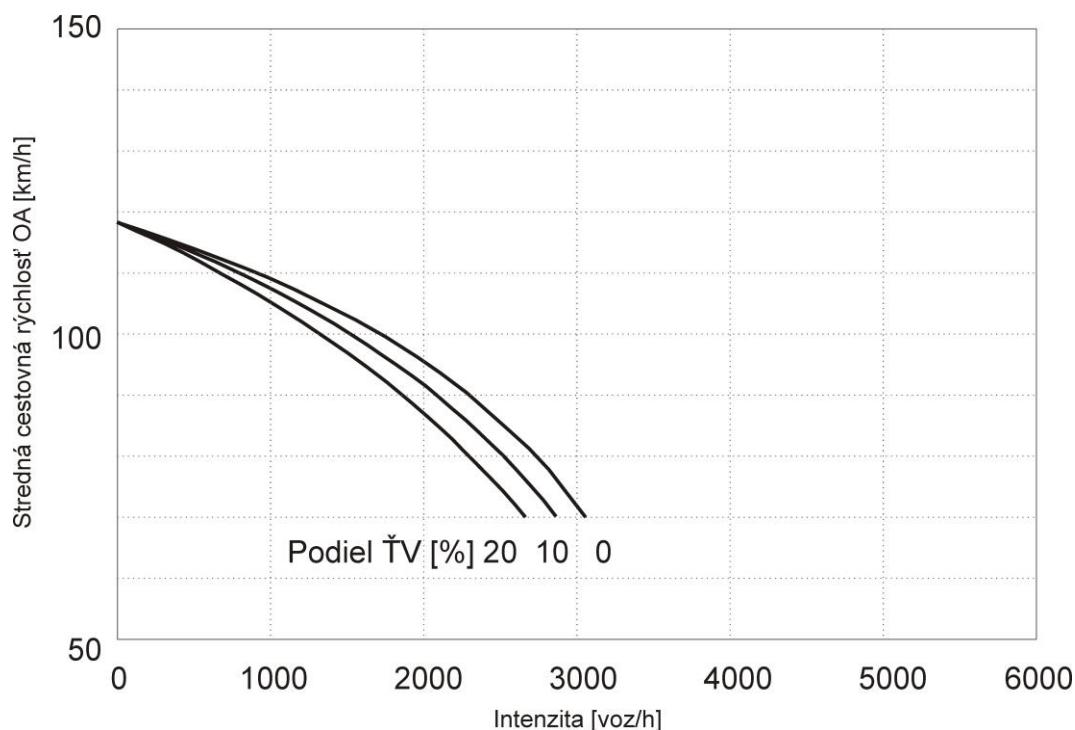
Obrázok 4.4(d) Stredná cestovná rýchlosť OA v závislosti na intenzite dopravného prúdu, stúpanie = 5 % (2-pruhová diaľnica, v aglomerácii, bez obmedzenia rýchlosťi)
