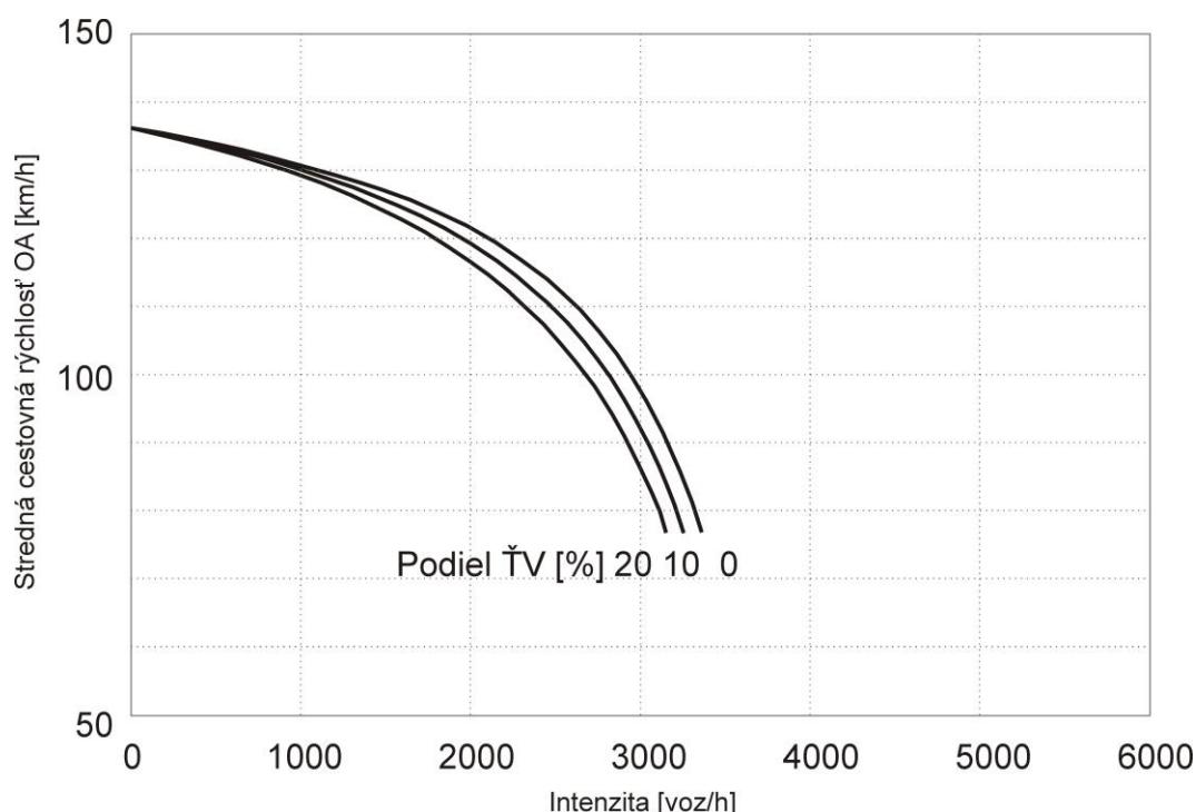
Obrázok 4.3(b) Stredná cestovná rýchlosť OA v závislosti na intenzite dopravného prúdu, stúpanie = 3 % (2-pruhová diaľnica, mimo aglomerácie, bez obmedzenia rýchlosťi)
