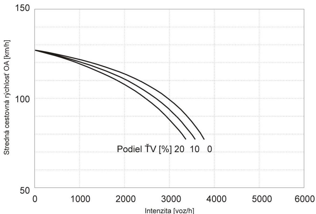
Obrázok 4.4(b) Stredná cestovná rýchlosť OA v závislosti na intenzite dopravného prúdu, stúpanie = 3 % (2-pruhová diaľnica, v aglomerácii, bez obmedzenia rýchlosťi)
