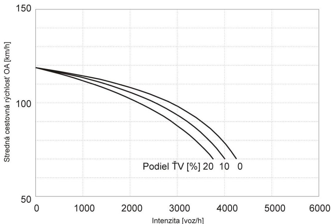
Obrázok 4.2(d) Stredná cestovná rýchlosť OA v závislosti na intenzite dopravného prúdu, stúpanie = 5 % (3-pruhová diaľnica, v aglomerácii, bez obmedzenia rýchlosťi)
