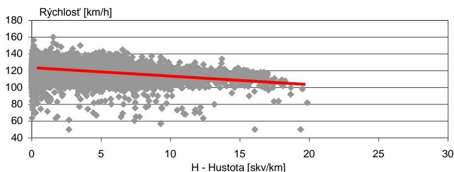
Obrázok 3.17 Vzťah okamžitej rýchlosťi a hustoty dopravného prúdu (V/H diagram)
