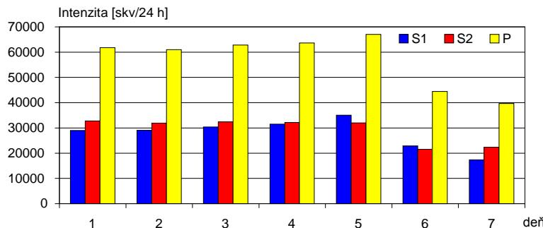
Obrázok 3.5 Mesačný priemer denných intenzít dopravy (pondelok – nedeľa)
