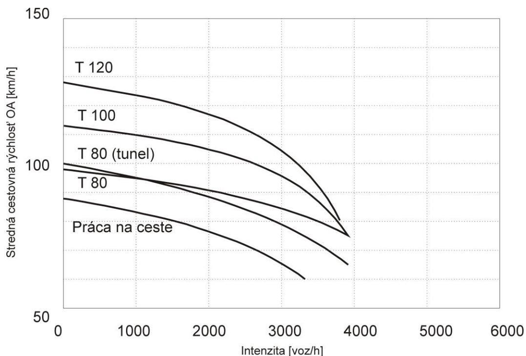
Obrázok 4.6 Stredná cestovná rýchlosť OA v závislosti na intenzite premávky (cca 10 % podiel ťažkých vozidiel), 2-pruhová diaľnica mimo aglomerácie, s trvalým obmedzením rýchlosťi, alebo práca na ceste (platí pre: rovina, klesanie, max. 2 % stúpanie)
