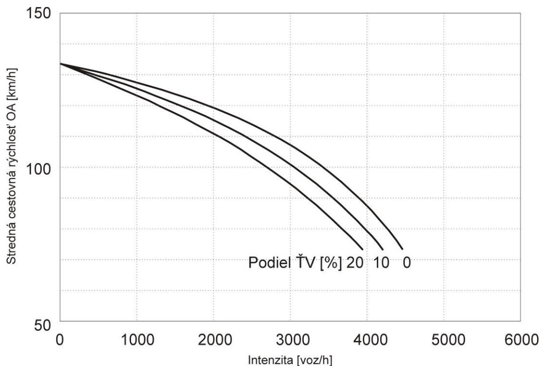
Obrázok 4.1(c) Stredná cestovná rýchlosť OA v závislosti na intenzite dopravného prúdu, stúpanie = 4 % (3-pruhová diaľnica, mimo aglomerácie, bez obmedzenia rýchlosťi)
