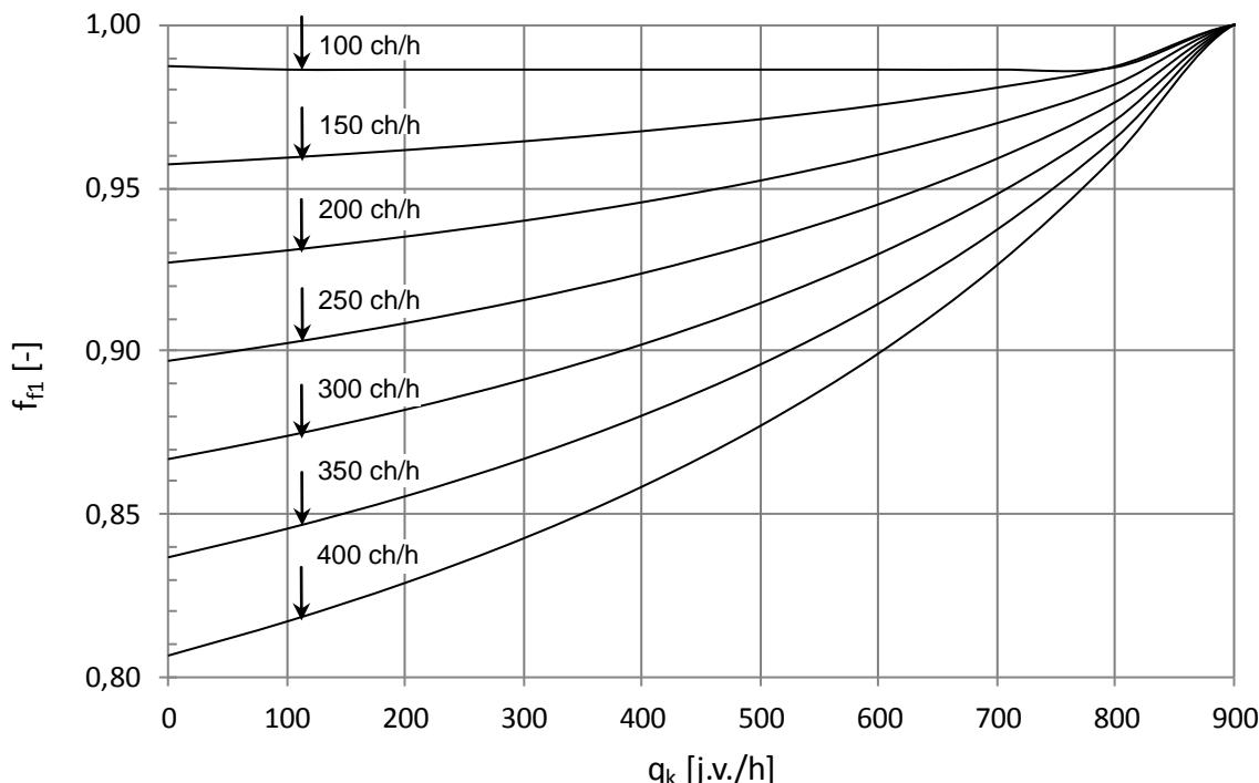
Obrázok 8.6 Koeficient  $f_{f1}$  obmedzujúceho vplyvu chodcov na jednopruhových vjazdoch na jednopruhový okružný jazdný pás
