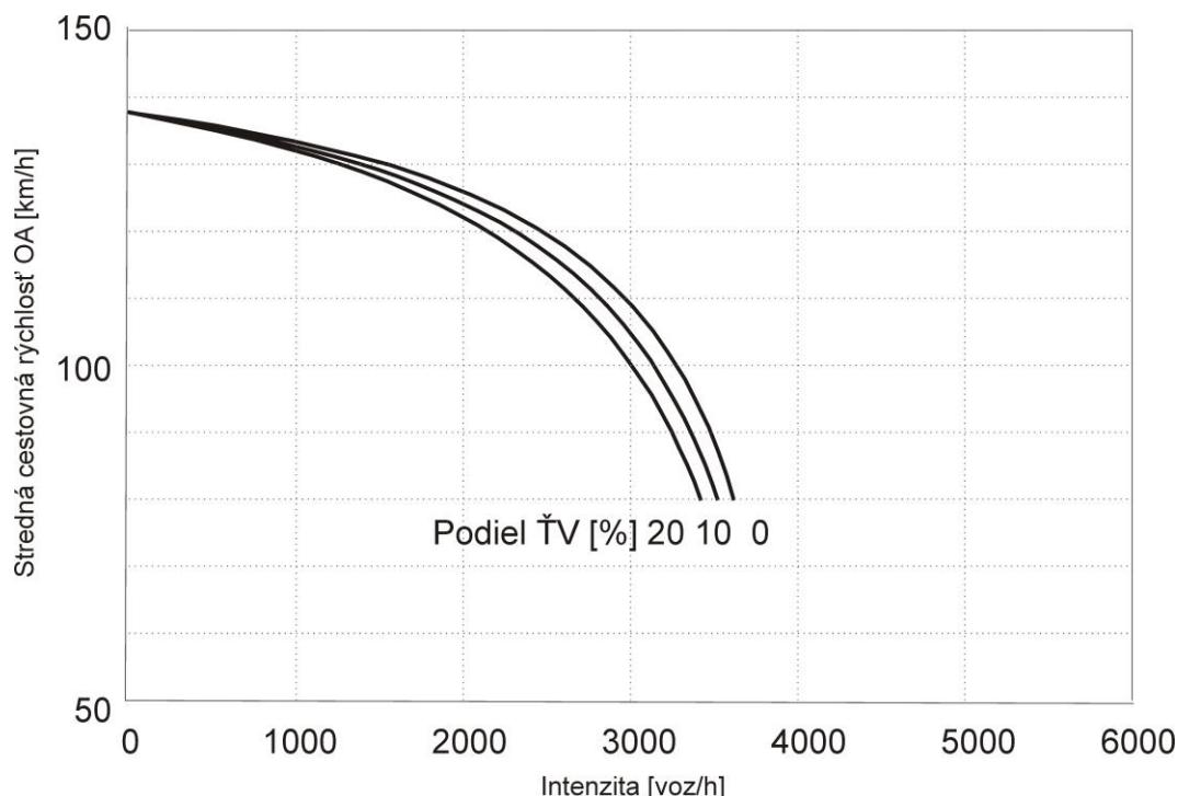
Obrázok 4.3(a) Stredná cestovná rýchlosť OA v závislosti na intenzite dopravného prúdu, stúpanie  $\leq 2\%$  (2-pruhová diaľnica, mimo aglomerácie, bez obmedzenia rýchlosťi)
