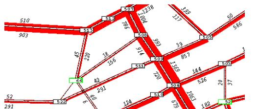
Obrázok 3.25 Začaženie komunikačnej siete bez rozdelenia druhu dopravy podľa CSD
