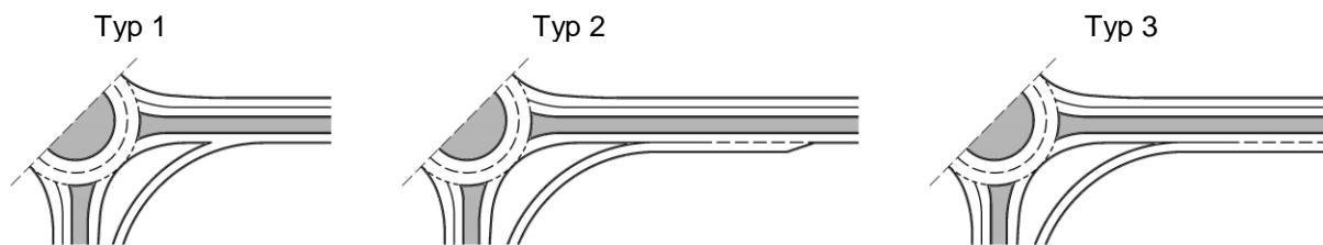
Obrázok 8.11 Tri základné typy spojovacích vetiev OK podľa spôsobu napojenia na výjazd
