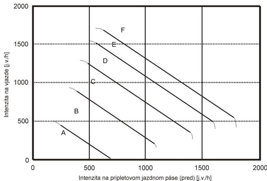
Obrázok 5.8 Stupeň kvality dopravných prúdov pre prepletanie na priepletovom páse typu VR 1 v závislosti od intenzity priepletového pásu pred priepletovým úsekom a intenzity vjazdu
