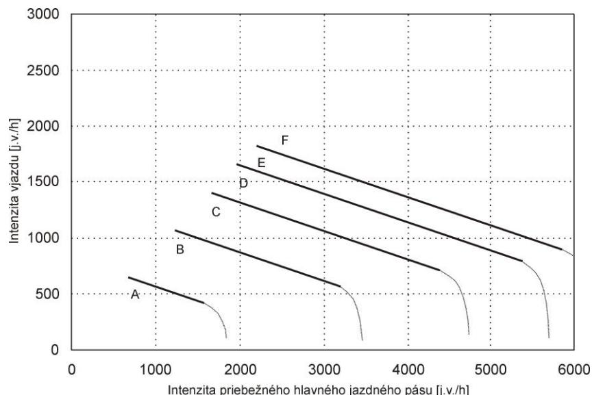
Obrázok 5.3 Stupeň kvality dopravných prúdov pre priebeh zaraďovania v závislosti od intenzity dopravy priebežných hlavných jazdných pásov a intenzity vjazdu pre typ vjazdu E1 a E2 na 3-pruhovom jednosmernom jazdnom páse
