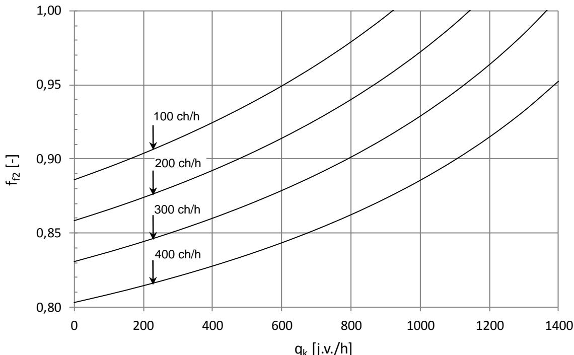
Obrázok 8.7 Koeficient  $f_2$  obmedzujúceho vplyvu chodcov na jednopruhových a dvojpruhových vjazdoch na dvojpruhový okružný jazdný pás
