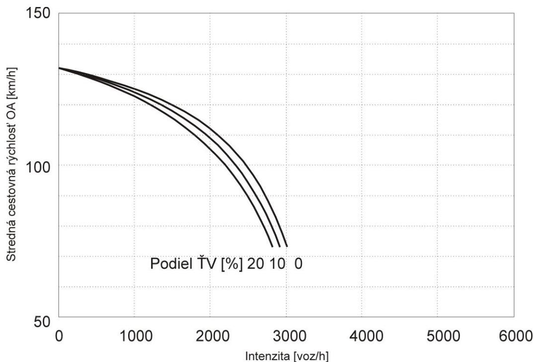
Obrázok 4.3(c) Stredná cestovná rýchlosť OA v závislosti na intenzite dopravného prúdu, stúpanie = 4 % (2-pruhová diaľnica, mimo aglomerácie, bez obmedzenia rýchlosťi)
