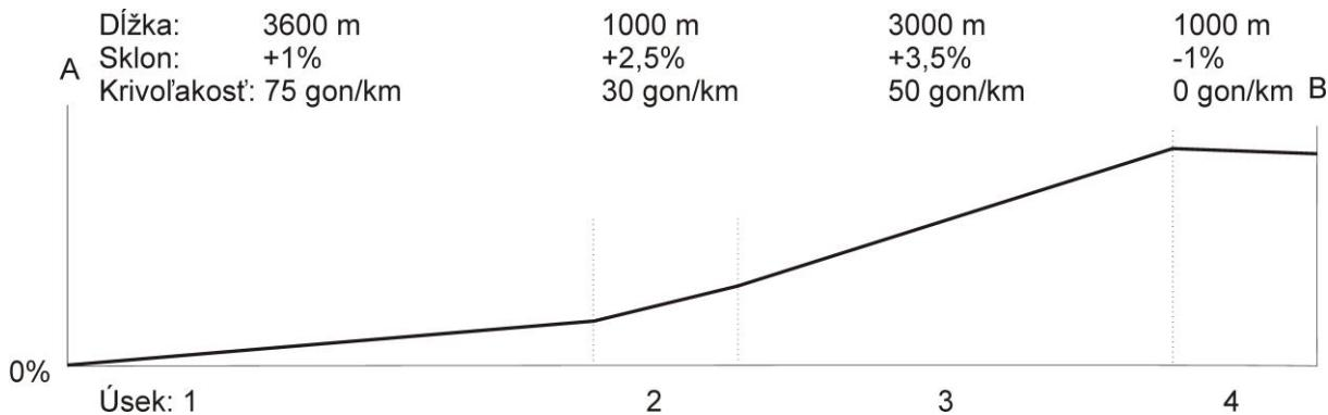
Obrázok 10.3 Náčrt pozdĺžneho profilu úseku pre príklad
