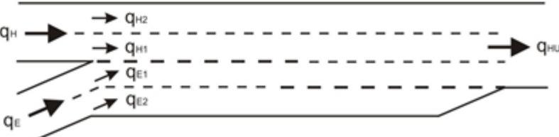
Obrázok 5.1 Typy vjazdov (schematické) a označenie jazdných prúdov
