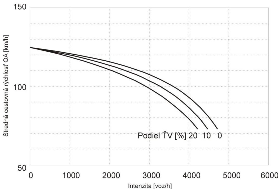
Obrázok 4.2(c) Stredná cestovná rýchlosť OA v závislosti na intenzite dopravného prúdu, stúpanie = 4 % (3-pruhová diaľnica, v aglomerácii, bez obmedzenia rýchlosťi)
