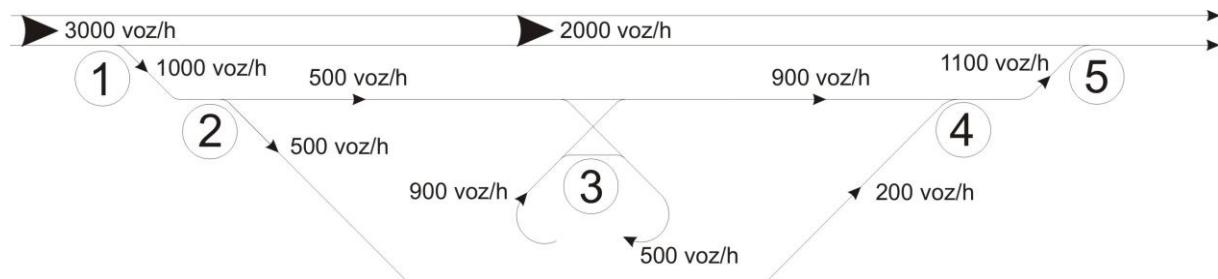
Obrázok 10.2 Schéma vedenia jazdných prúdov pre výpočtový príklad
