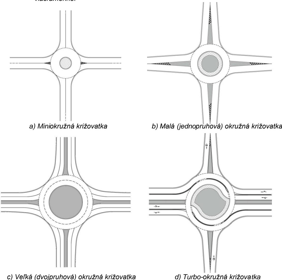
Obrázok 8.2 Typy moderných okružných križovatiek
