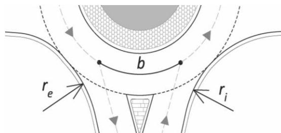
Obrázok 8.4 Vzdialenosť medzi kolíznym bodom vjazdu a výjazdu na posudzovanom ramene okružnej križovatky
