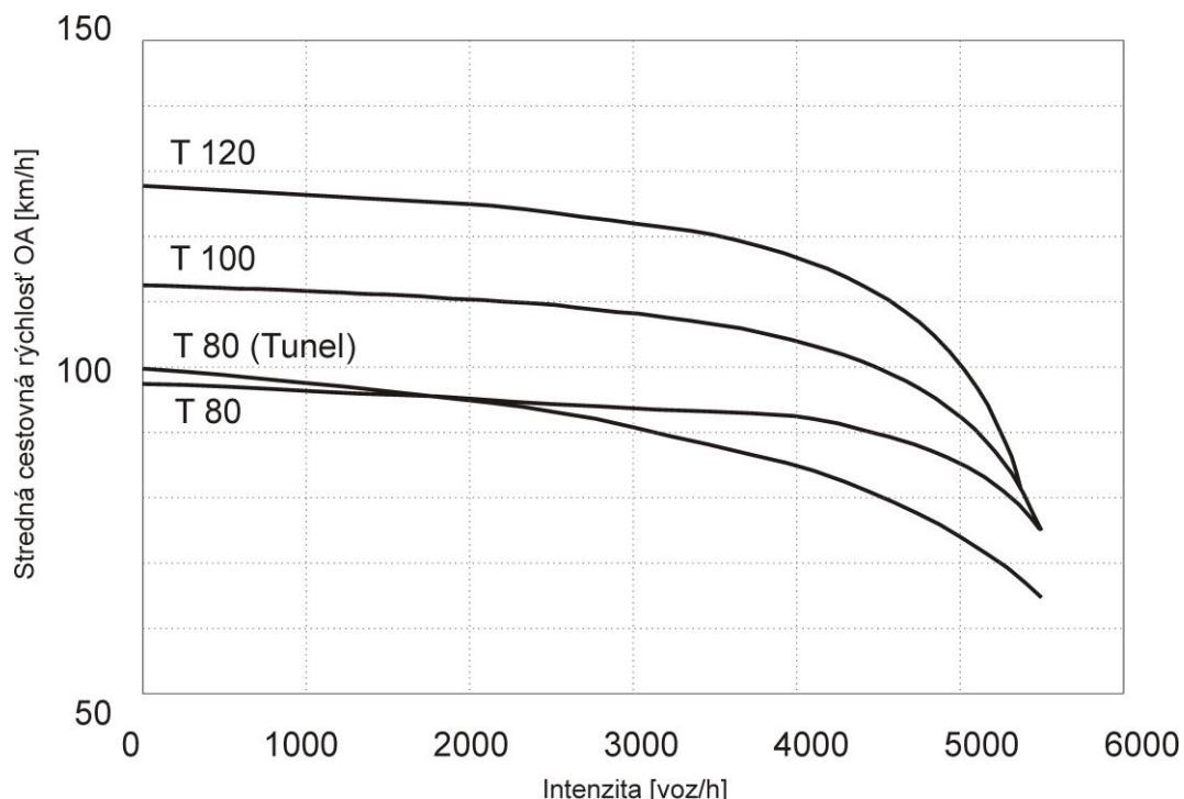
Obrázok 4.5 Stredná cestovná rýchlosť OA v závislosti na intenzite premávky (cca 10 % podiel ťažkých vozidiel, 3-pruhová diaľnica mimo aglomerácie, s trvalým obmedzením rýchlosťi (platí pre: rovina, klesanie, max. 2 % stúpanie))
