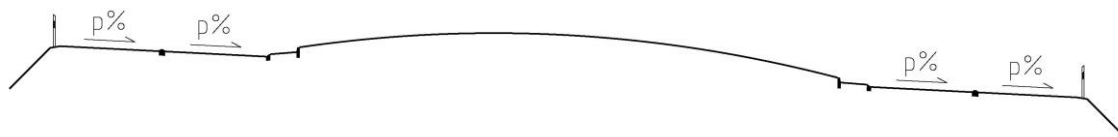
Obrázok 4.5 Priečny sklon okružného jazdného pásu
