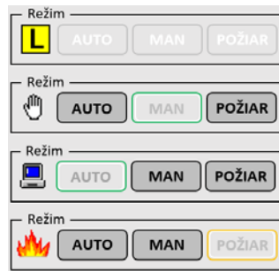
Obrázok 24 - Okno detailných informácií – voľba a signalizácia režimu prevádzky
