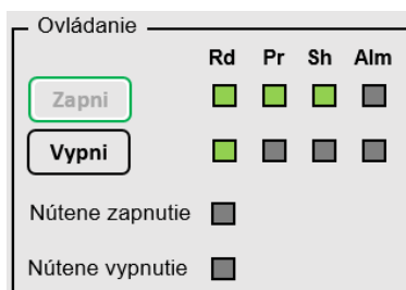
Obrázok 26 - Okno detailných informácií, oblasť ovládania, signalizácia zapnutia zariadenia – príklad
