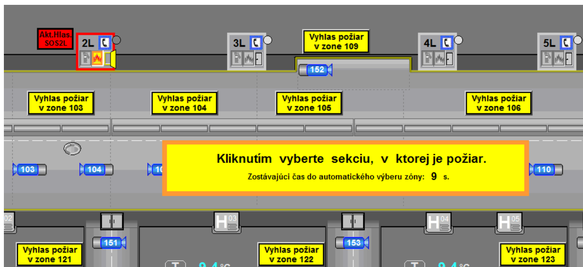
Obrázok 41 - Výrez bezpečnostnej technologickej obrazovky, keď niekto v SOS kabíne/výklenku aktivoval tlačidlový požiarový hlásič (začne sa odpočítavať čas)
