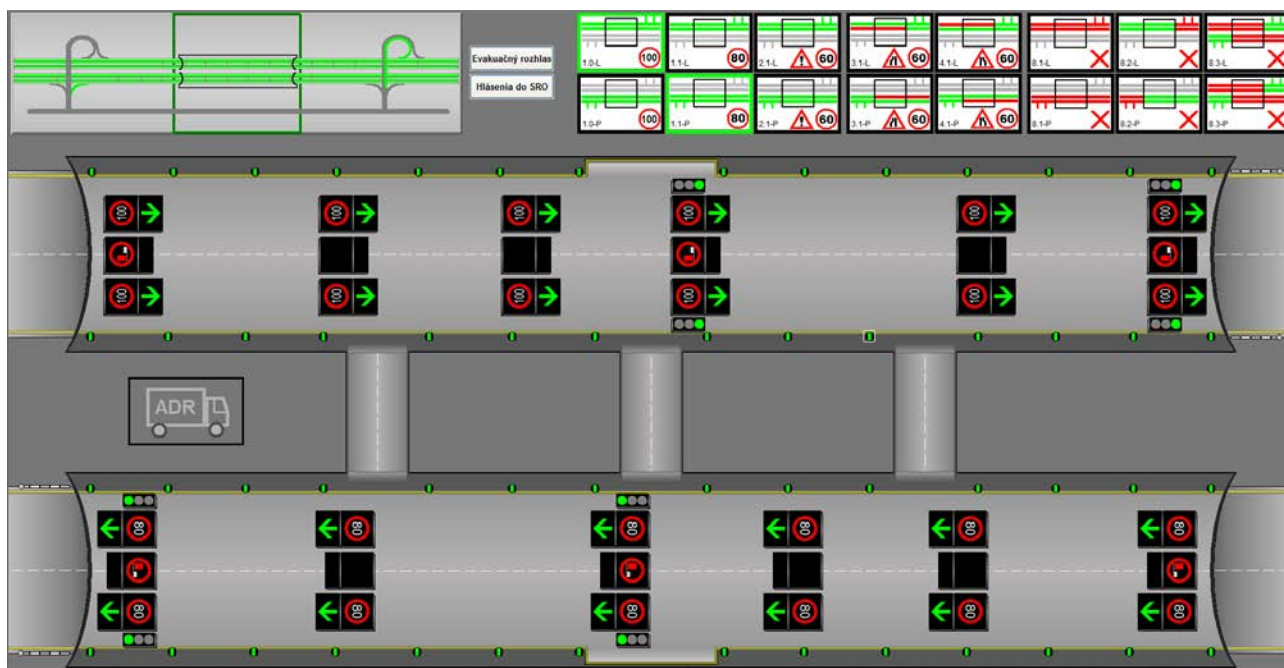
Obrázok 34 - Príklad technologickej obrazovky dopravy – časť tunel
