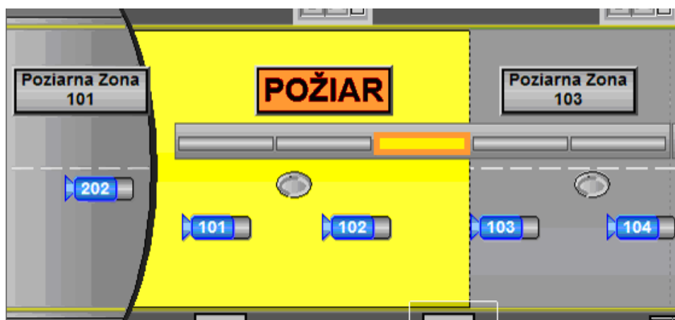
Obrázok 40 - Výrez bezpečnostnej technologickej obrazovky, keď lineárny teplotný hlásič vyhlásil požiar v zóne
