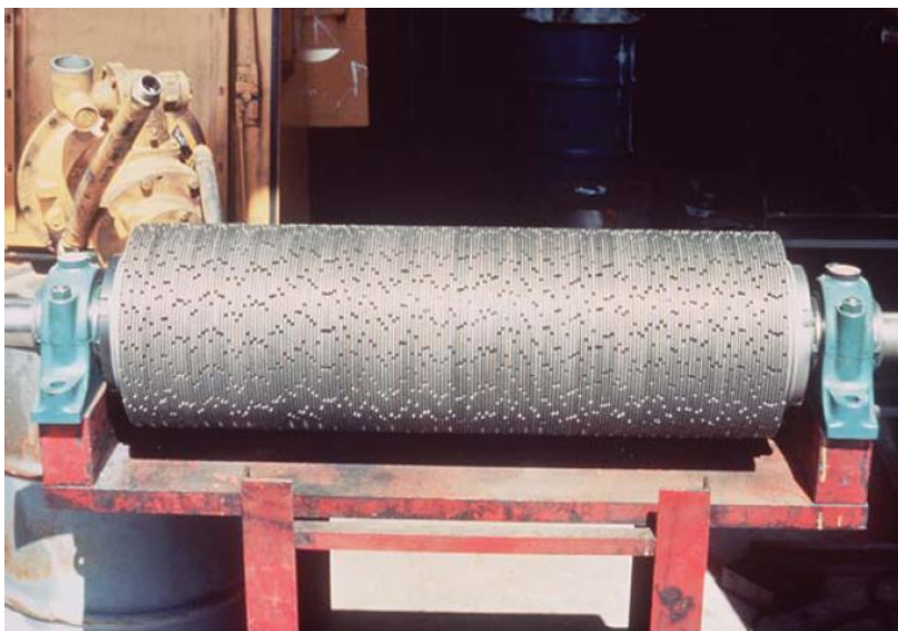
Rezné kotúče na horizontálnom hriadeli
