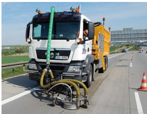
Príklad zapojenia zostavy dvoch trysiek
