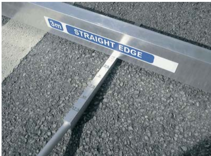
Obrázok 4 Lata na meranie nerovností povrchu podľa STN EN 13036-7
