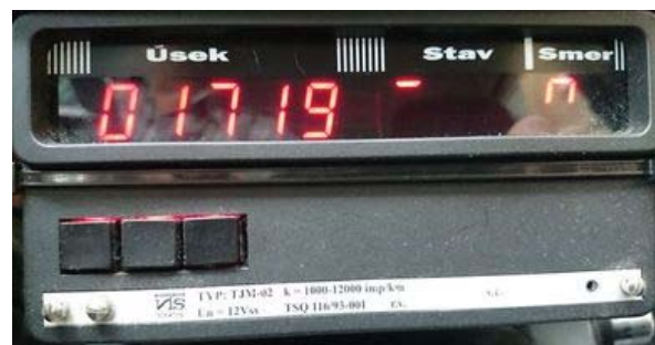
Obrázok 3 Dĺžkomer v meracom vozidle
