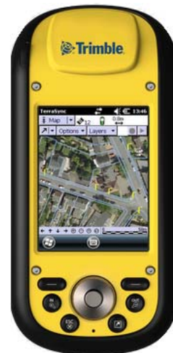
Obrázok 5 Ručné GPS zariadenie s presnosťou zamerania polohy na 1 m
