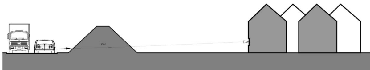
Obrázok 8 Schematické znázornenie zemného valu pri zástavbe
