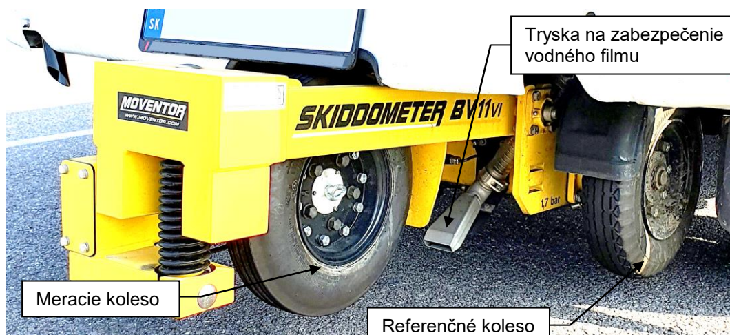
Obrázok 2 Meracia jednotka zariadenia Skiddometer BV 11 VI
