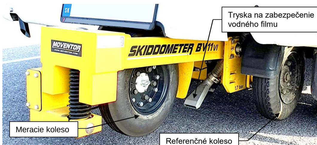
Obrázok 2 Meracia jednotka zariadenia Skiddometer BV 11 VI
