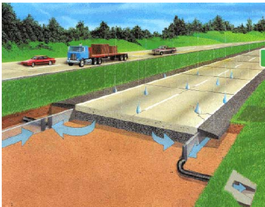
Obrázok 10 – Aplikácia pásovej drenáže na cestnej komunikácii
