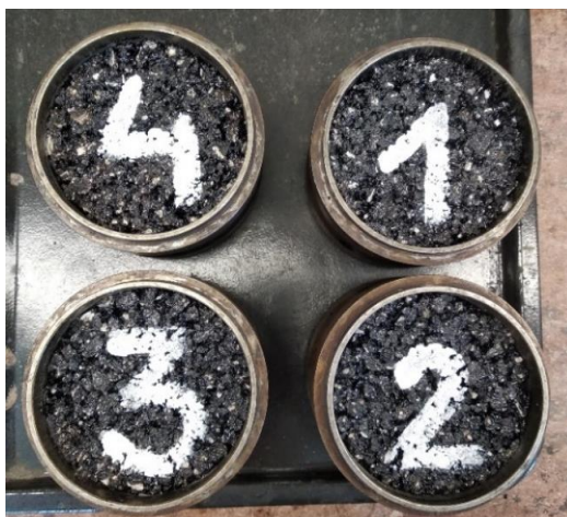
Obrázok 27 – Vzorky na určenie objemovej hmotnosti zhutnenej asfaltovej zmesi AC 22 podklad
