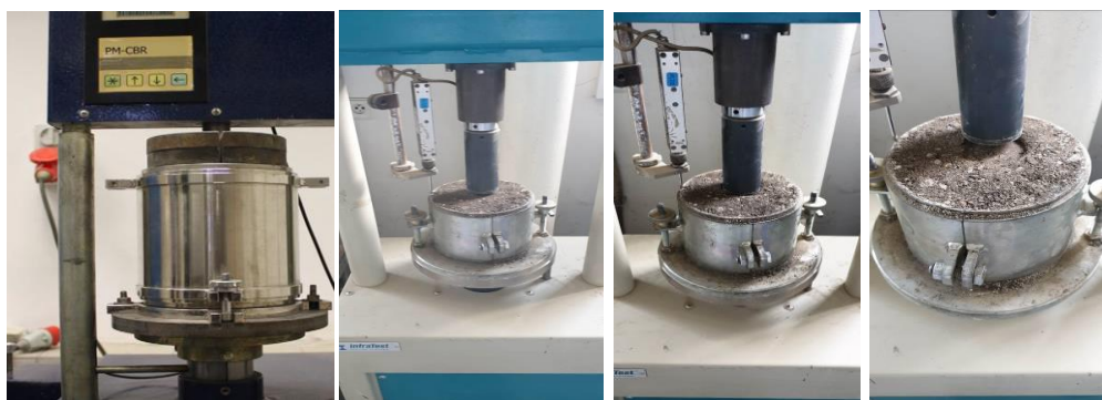
Obrázok 45 – Zaťažovanie vzorky pri skúške CBR a IBI [L11]
