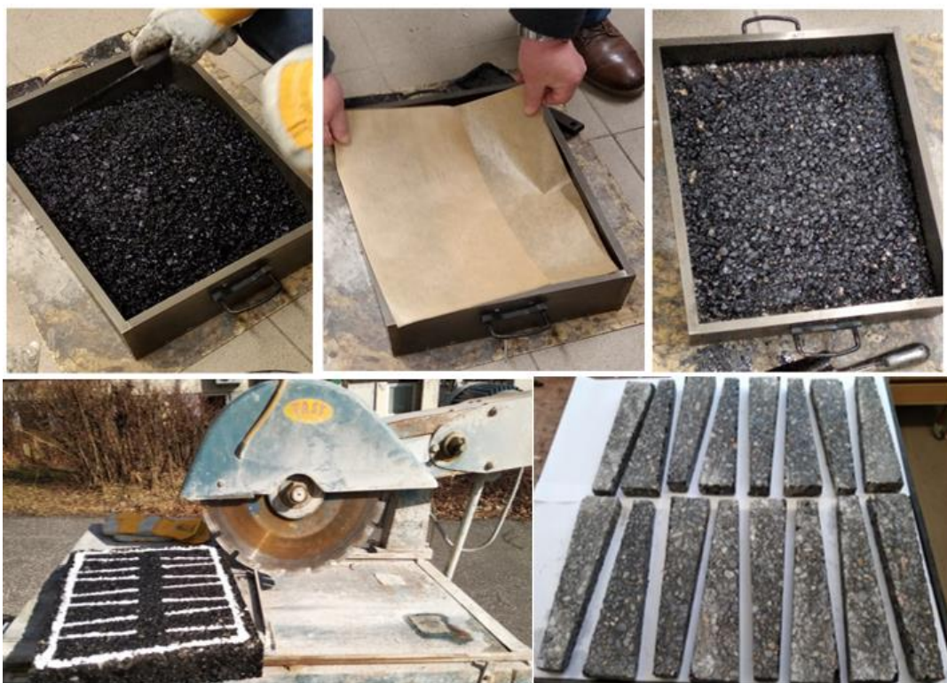
Obrázok 34 – Príprava skúšobných telies na vykonanie funkčných skúšok asfaltových zmesí
