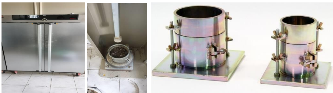
Obrázok 44 – Pohľady na použité prístroje pre skúšky PS a PM sušiareň, zhutňovanie vzorky a použité skúšobné valce [L11]
