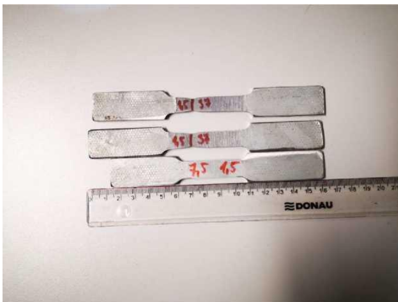
Obrázok 14 – Vzorka pre ťahovú skúšku a skúšku vrubovej húževnatosti
