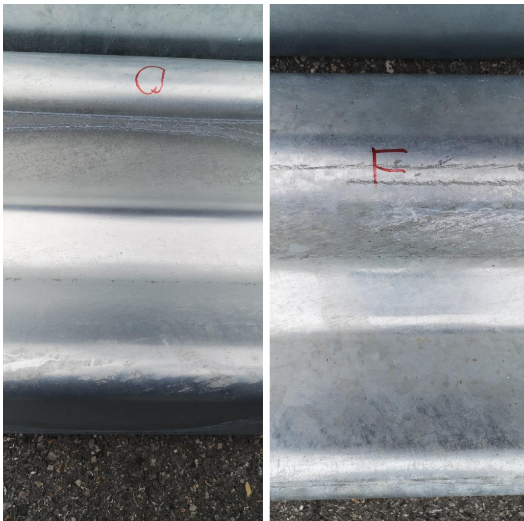
Obrázok 34 – Viditeľný rozdiel v povrchovej zinkovej úprave zvodnice - vľavo originálna, vpravo neoriginálna
