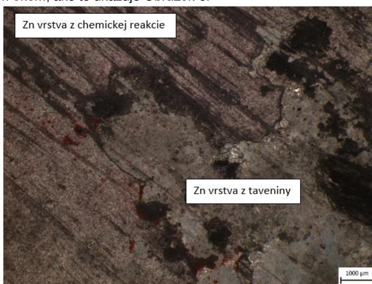
Obrázok 6 – Fotografia povrchu so Zn vrstvou, ako ju ukazuje v priečnom reze Obrázok 2g, h
