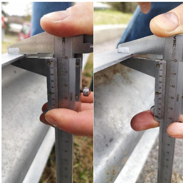
Obrázok 36 – Meranie hrúbok zvodníc - vľavo originálna, vpravo neoriginálna
