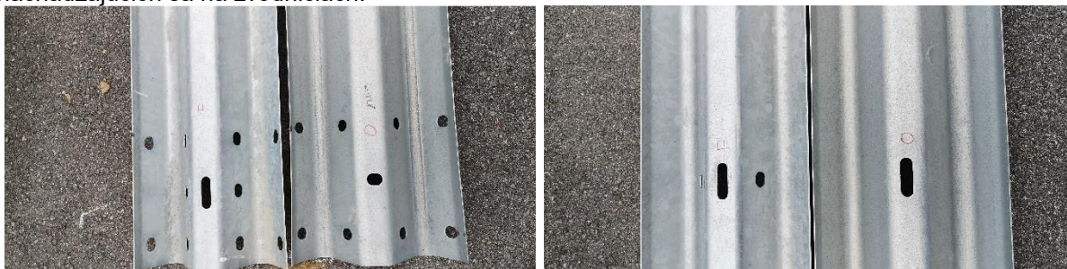
Obrázok 35 – Rozdiely zistené v počte a tvare otvorov - vľavo kraj zvodníc, vpravo stred zvodníc
