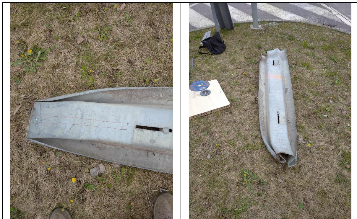
Obrázok 61 – Deformovaná zvodnica využitá pri analýze vplyvu deformácie na MBN
