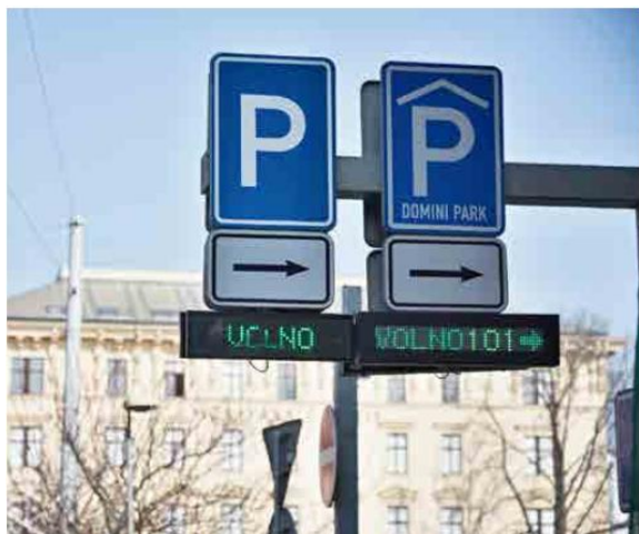
Obrázok 22 - Premenný profil navádzania na parkovací dom DOMINI PARK a premenný profil navádzania na vybrané parkoviská.
