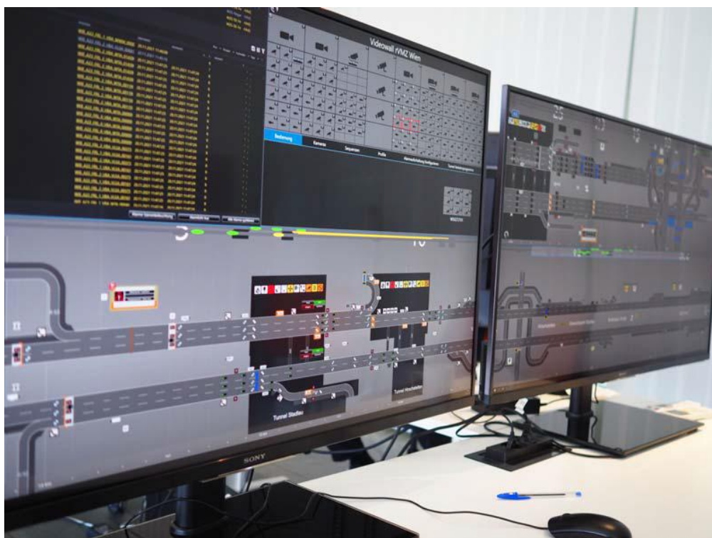
Obrázok 14 - Jednotné, integrované užívateľské rozhranie pre ovládanie, riadenie všetkých vonkajších zariadení
