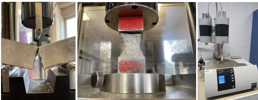
Obrázok 1 – Pevnosť mált v ťahu pri ohybe a v tlaku a termická analýza
