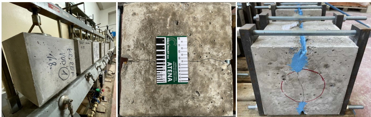
Obrázok 3 – Skúška hĺbky presiaknutia tlakovou vodou a tvorba trhliny do 0,4 mm
