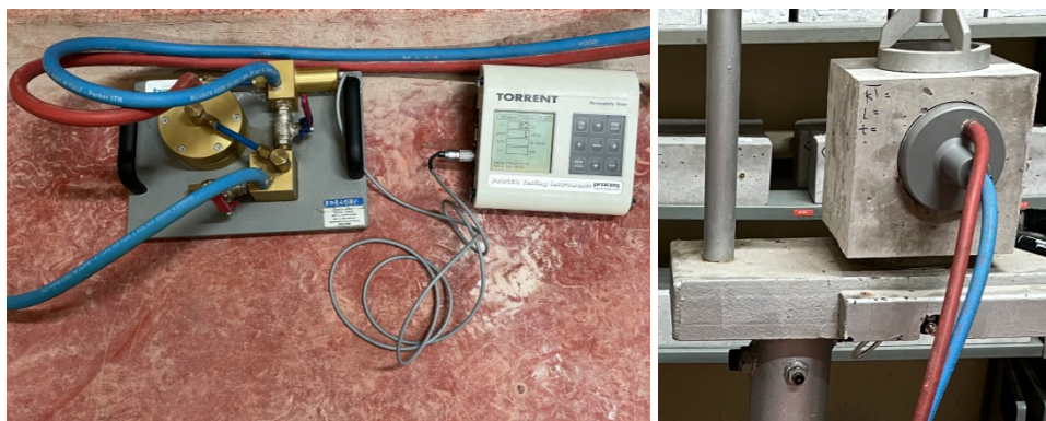
Obrázok 2 – Stanovenie permeability zatvrdnutého betónu prístrojom TORRENT
