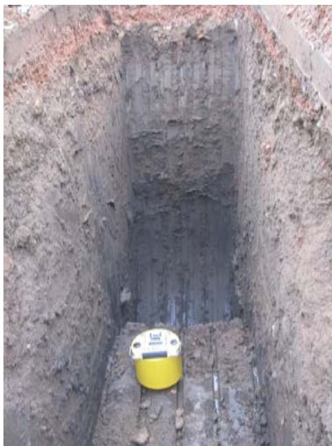
Obrázok 2 - Meranie deformačných parametrov zeminy v kopanej sonde dynamickou zaťažovacou skúškou geosondou HUMBOLDT H-4140
