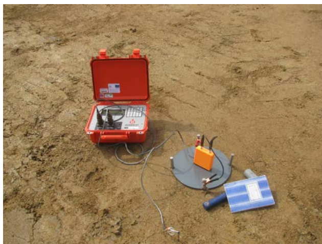
Obrázok 18 - Meranie miery zhutnenia zeminy elektrickým hutnomerom Humboldt H-4114C
