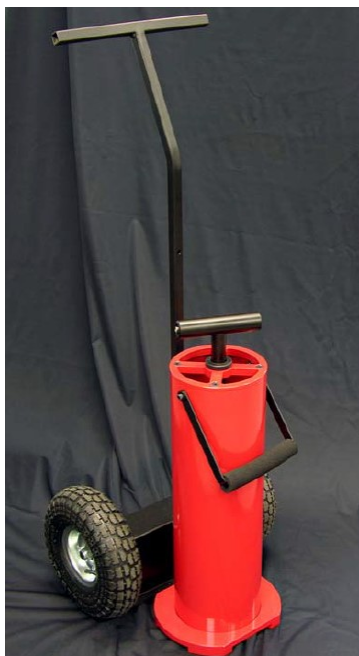
Obrázok 15 - Cleggovo kladivo 10 kg s transportným zariadením
