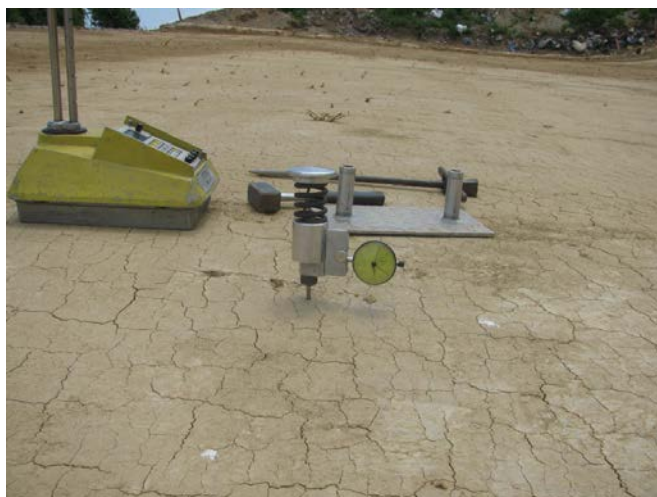
Obrázok 25 - Kontrola kvality vrstvy minerálneho tesnenia skládky odpadu radiačným hutnomerom (starší, už nevyrábaný model) v kombinácii s ručnou statickou penetráciou (Proctorova ihla)
