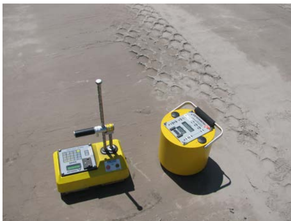
Obrázok 1 - Porovnávacie meranie medzi geosondou Humboldt a radiačným hutnomerom Troxler
