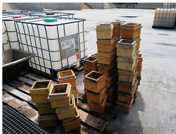
Obr. 10: Formy pre výrobu vzoriek na nasiakavosť
