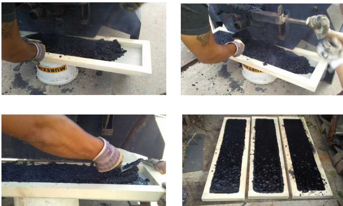
Obrázok 9 – 14 Príprava vzoriek na skúšky asfaltovej zmesi MA 11 O PMB 10/40-65
