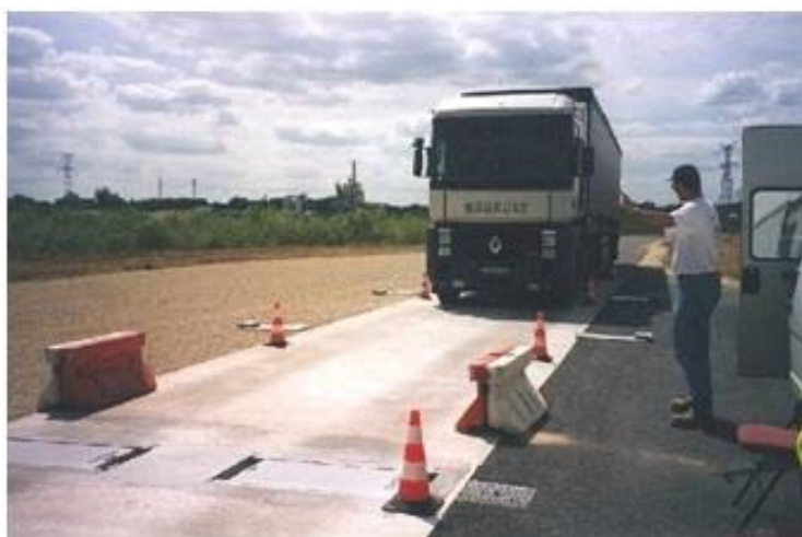
Obrázok 11 - Nízkorýchlostné váženie, Zdroj: ISWIM
