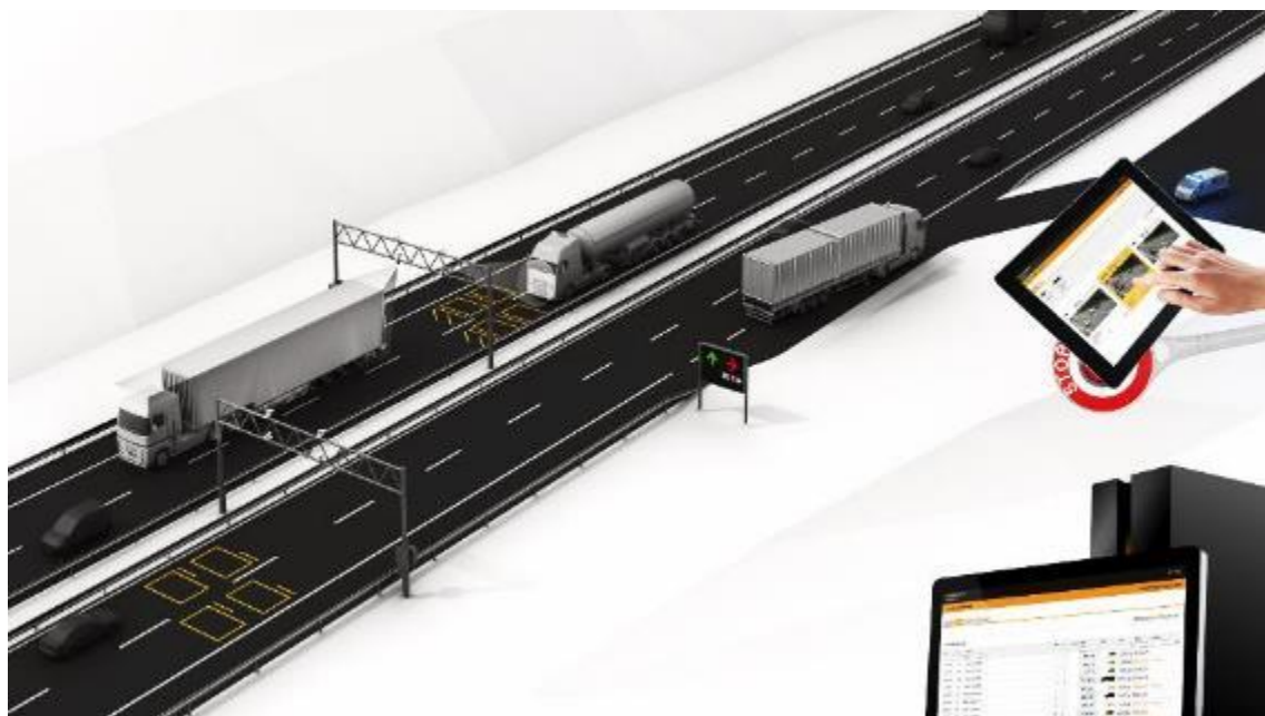
Obrázok 34 - Schéma WIM portálu
