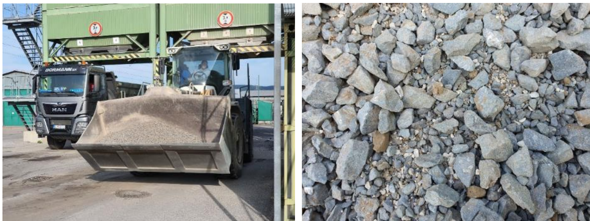
Obr. 14 a 15 Vizuálna kontrola rozmiešania zmesi v horúcom kamenive
