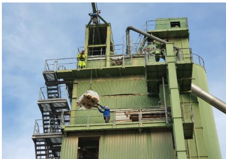
Obr. 12 a 13 Uloženie prísady na VAZ
