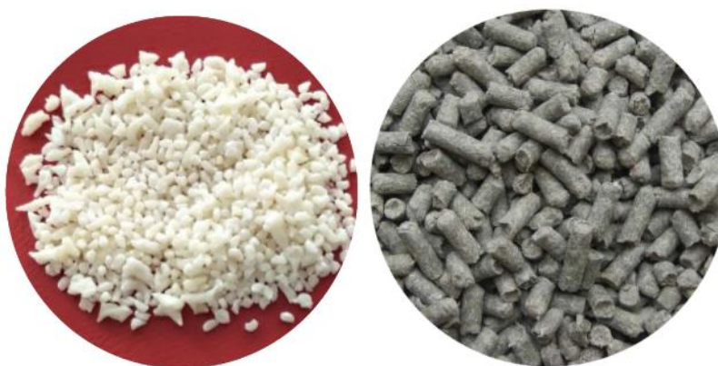
Obrázok 5 Rôzne formy prísad (granulát a pelety) na výrobu PMAZ
