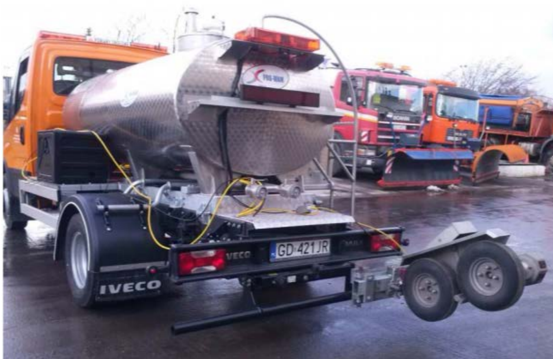
Obrázok 12 Zariadenie TMO pre meranie šmykového odporu [77]
