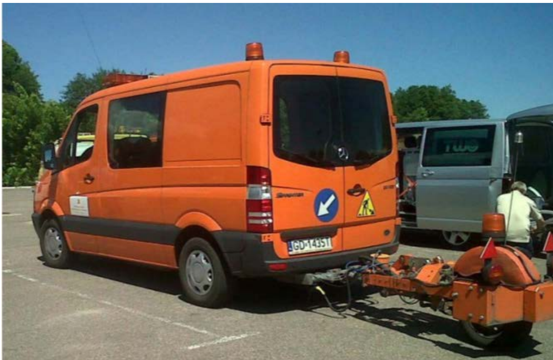
Obrázok 11 Zariadenie SRT-3 pre meranie šmykového odporu [76]
