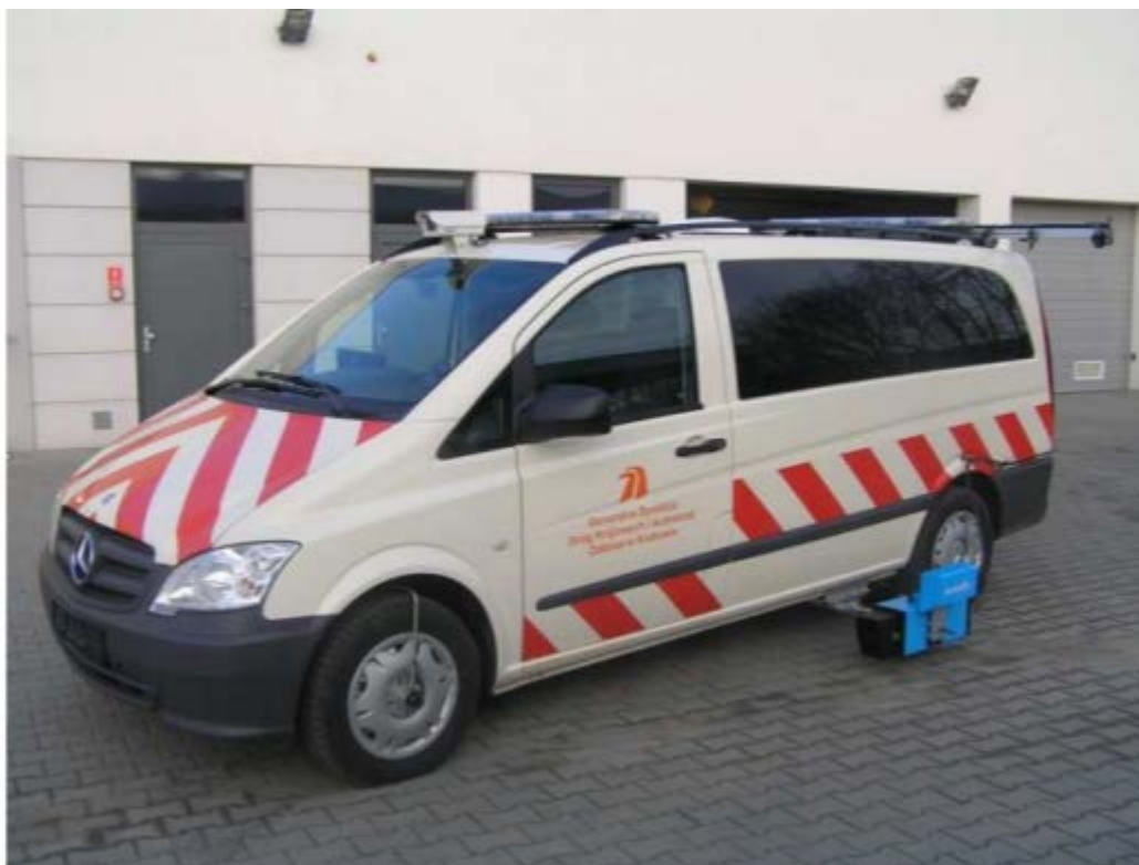
Obrázok 13 Zariadenie RMT 2.0 pre meranie parametrov vodorovného dopravného značenia [77]
