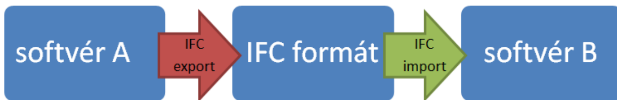
Obr. 5.1 Princíp zobrazovania BIM modelu v rôznych softvérových riešeniach
