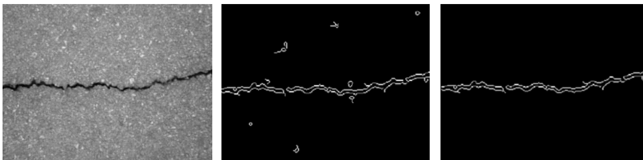
Obrázok 5 Príklad aplikácie Cannyho detektoru hrán. Obrázok vľavo je záznam trhliny; v strede je výsledok Cannyho detektora s parametrom prahu 0,4; vpravo s parametrom prahu 0,5. Prevzaté z [18].
