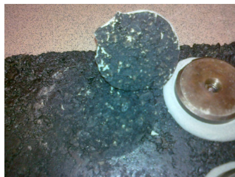
Obrázok 11 - Odtrhová skúška po cyklovaní
