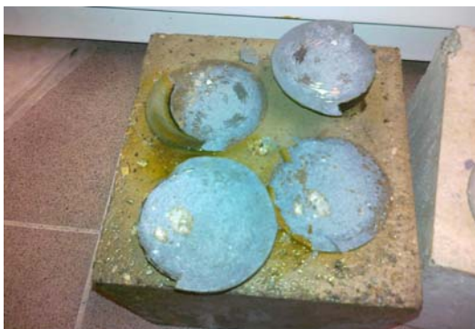
Obrázok 11 - Odtrhová skúška po cyklovaní
