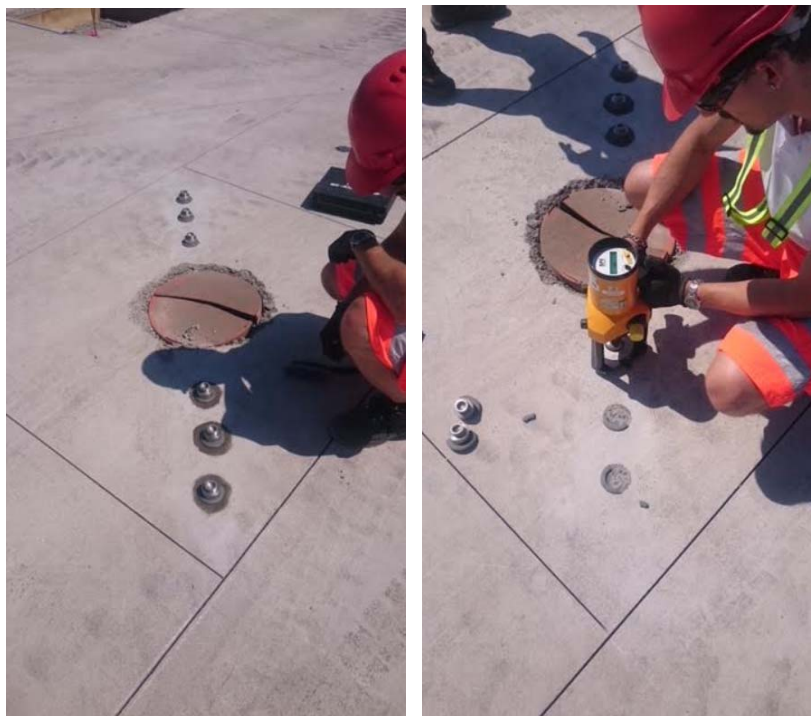
Obrázok 13 - Odtrhová skúška na referenčnom úseku v areáli automobilky Volkswagen
