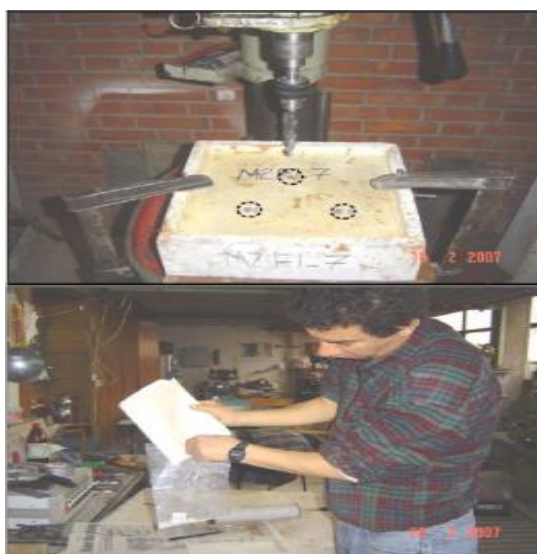
Obr. 10: Odoberanie vzoriek betónu pre chemický rozbor
