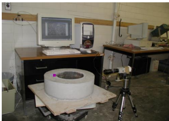
Obr. 5: Tzv. „ring test“
