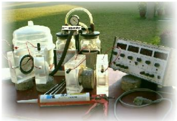
Obr. 11: Skúšobná aparatúra pre Rapid chloride permeability test
