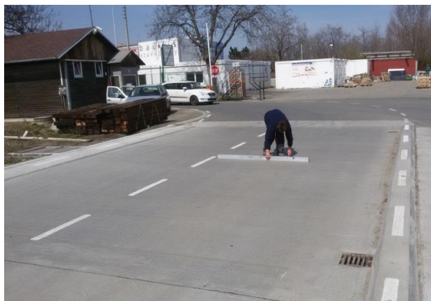
Obr. 87: Pohľad na most, meranie rovinnosti
