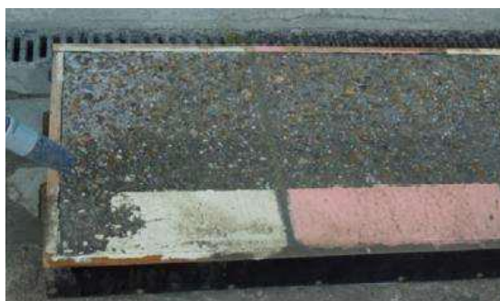
Obr. 83: Test hĺbky úpravy obnaženého kameniva
