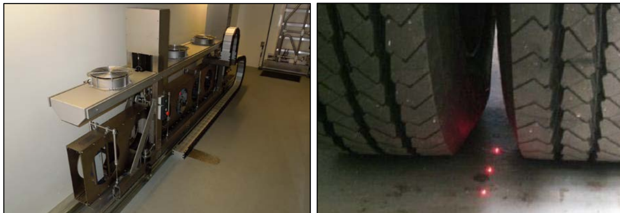
Obrázky 5 a 6: Nosník s Doppler-laser snímačmi; laserové lúče troch snímačov na povrchu vozovky
