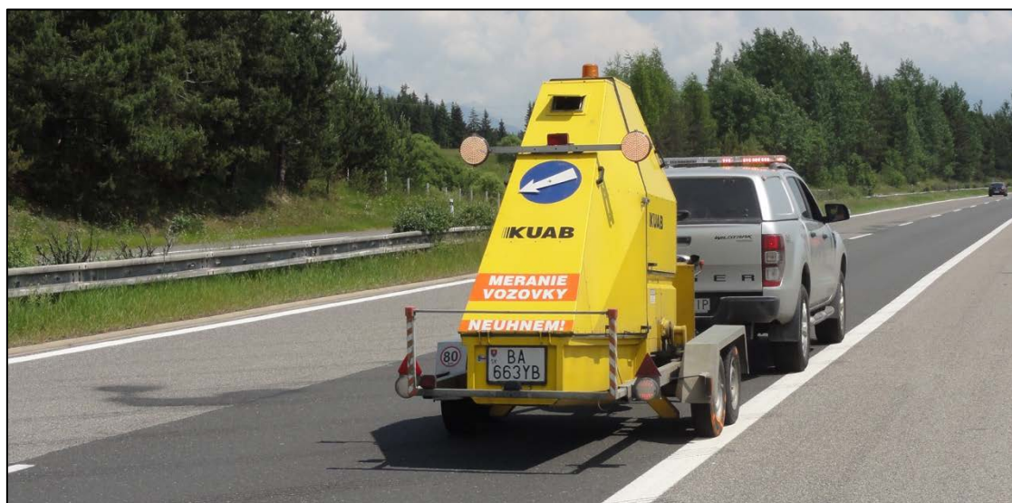
Obrázok 13: Deflektometer KUAB pri porovnávacom meraní FWD/TSD na diaľnici D1, dňa 9.6.2015
