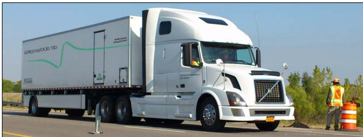
Obrázok 33: Americký TSD pri práci na MnRoad [13]
