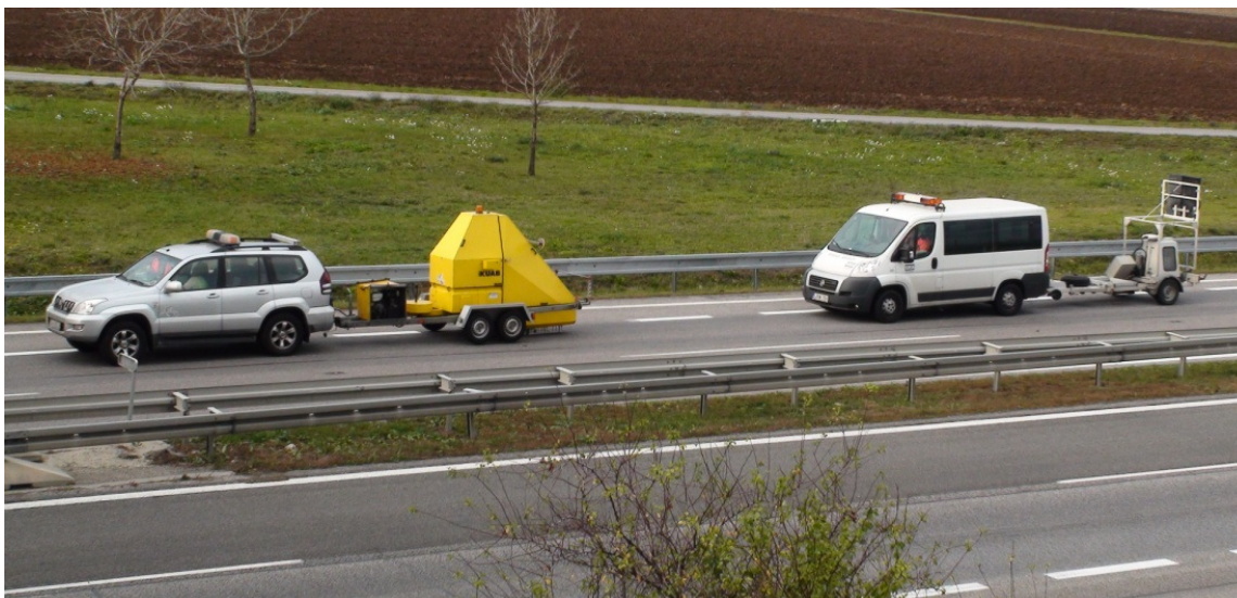
Obr.2: Meranie únosnosti pokusného úseku deflektometrami FWD typu KUAB a DYNATEST
