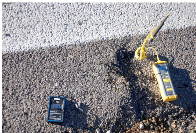
Obr. 3: Meranie teploty asfaltových vrstiev v rôznych hĺbkach pomocou snímačov osadených vo vozovke
