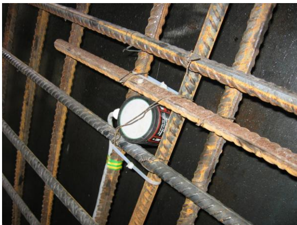
Obr. 41 Príklad použitia senzora koróznej rýchlosti
