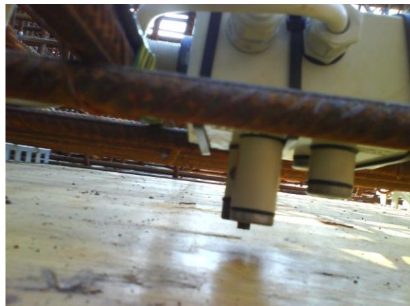
Obr. 42 Príklad použitia kombinovaného senzora – sondy VŠCHT
