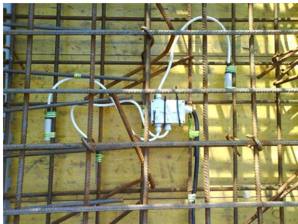
Obr. 42 Príklad použitia kombinovaného senzora – sondy VŠCHT
