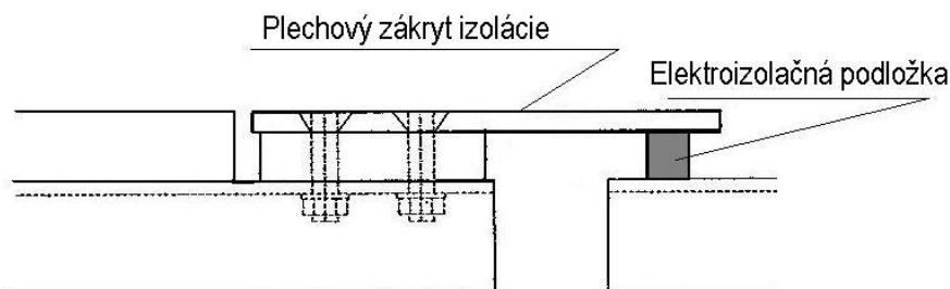
Obr. 20 Elektrické izolačné oddelenie plechového zákrytu
